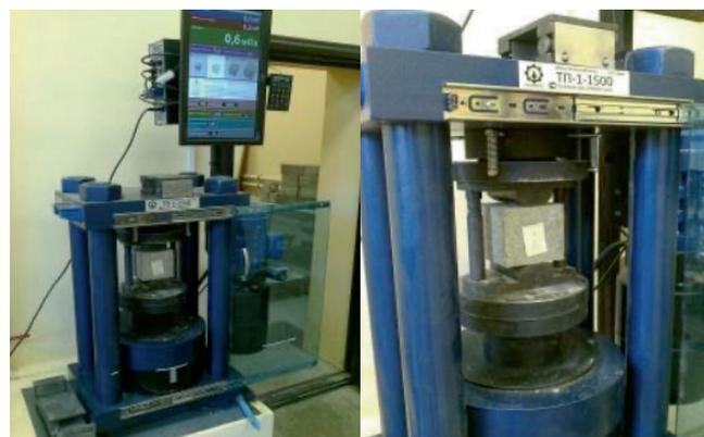
**Рис. 2.4.** Общий вид при испытании на раскалывание образца–куба размерами 10 × 10 × 10 см
