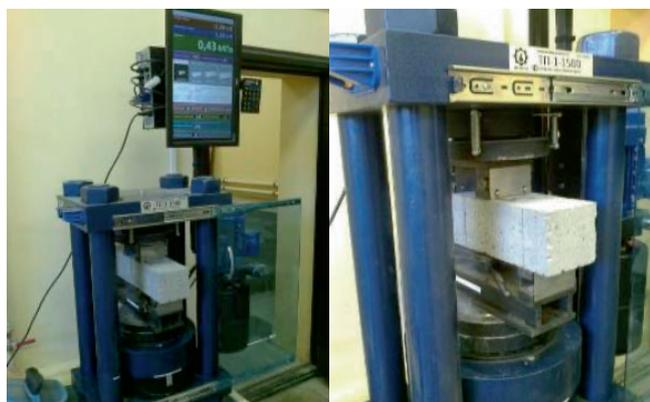
**Рис. 2.3.** Общий вид при испытании образца–призмы на растяжение при изгибе размерами 10 × 10 × 40 см
