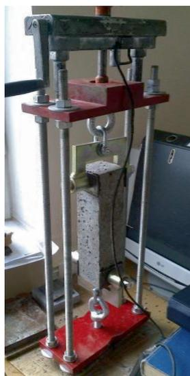
**Рис. 2.1б.** Общий вид при испытании на осевое растяжение образцов-призм размерами  $7 \times 7 \times 28$  см
