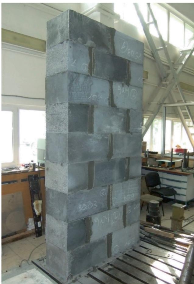
**Рис. 1.** Фрагмент стены перед испытанием на ветровую нагрузку
