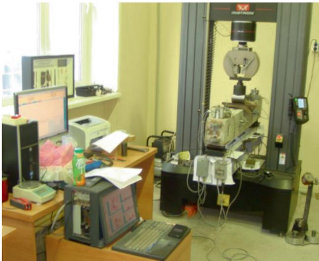
**Рис. 1.** Нагружающее устройство INSTRON 8802 с установленной балкой
