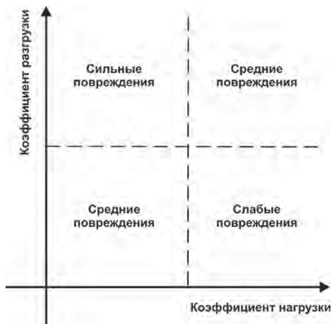
Рис. 3. Оценка степени повреждения железобетонных балок на основании коэффициента нагрузки L и коэффициента разгрузки CR
