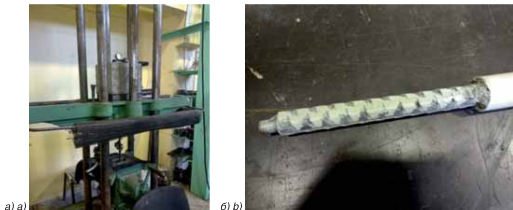
Рис. 7. Вытягивание арматуры из бетонных кубов: а) расположение образца в разрывной машине; б) вид арматурного стержня после испытаний Fig. 7. Pulling reinforcement from concrete cubes: а) the location of the sample in the bursting machine; б) the type of reinforcement rod after testing
