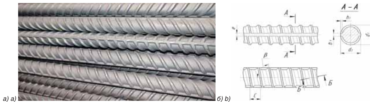
Рис. 11. Кольцевой периодический профиль: а) Общий вид; б) Конфигурация профиля
