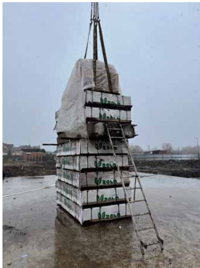
Рис. 5. 15-я ступень загрузки с максимальной нагрузкой 15,5 тс (автор фото Маслов П.С.)
