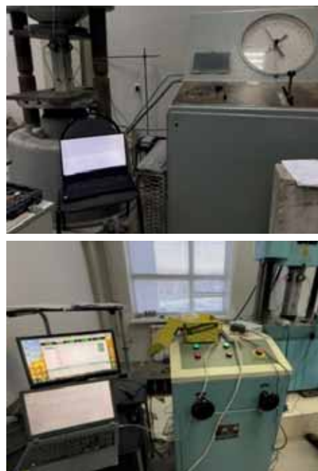
Рис. 1. Проведение испытаний на прессах «ПММ-125» и «Hydraulic Universal Testing Machine» модели WEW-600 (С.В. Кожуркин)
