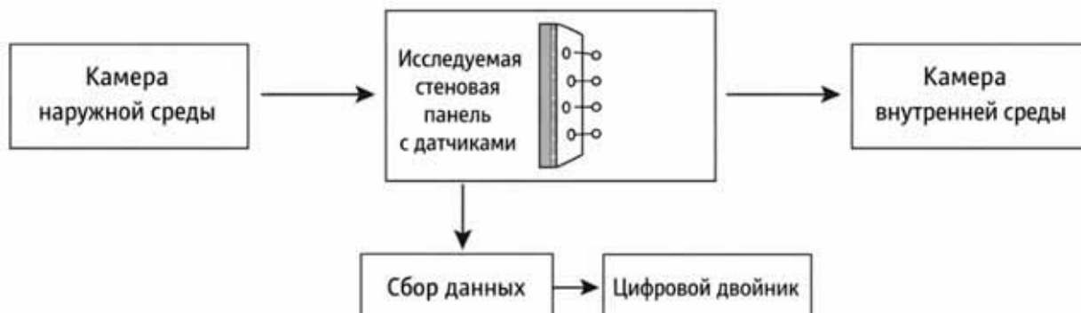
Рис. 3. Схема лабораторной экспериментальной установки Fig. 3. Diagram of the laboratory experimental setup
