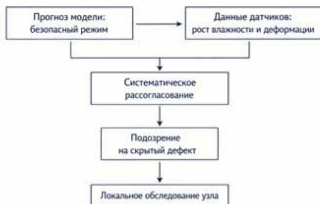
Рис. 10. Принцип выявления скрытого дефекта по рассогласованию прогнозных и измеренных параметров Fig. 10. Principle of detecting a hidden defect by the discrepancy between predicted and measured parameters
