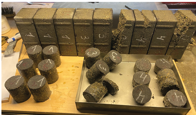
Рис. 2. Внешний вид образцов после 20 циклов испытаний по третьему ускоренному методу определения морозостойкости (Зиновьев А.А.©) Fig. 2. The appearance of the samples after 20 test cycles according to the third accelerated method for frost resistance determination (Zinoviev A.A.©)
