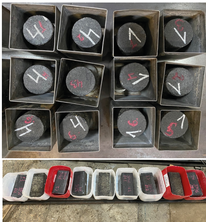
Рис. 1. Вид образцов перед испытанием на морозостойкость (Зиновьев А.А.©) Fig. 1. The appearance of the samples before the frost resistance test (Zinoviev A.A.©)
