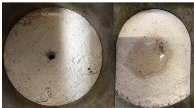
Рис. 9. Эксперимент 3. Примеры проверки наличия или отсутствия воды в отверстии от лески при давлении 0,5 МПа. Слева отсутствует «–», справа присутствует «+»
