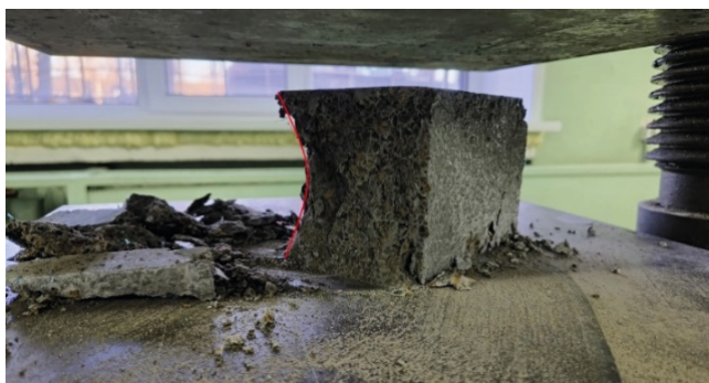
Рис. 8. Разрушение образца после испытаний, форма – песочные часы (выделено красным)
