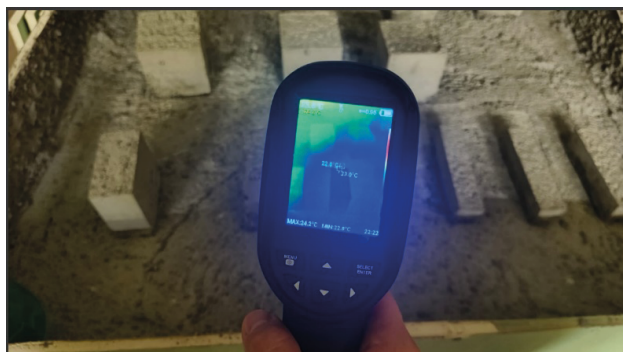
Рис. 4. а – образцы, извлеченные из опалубки; б – контроль температуры образцов Fig. 4. a – samples removed from the formwork; b – temperature control of samples
