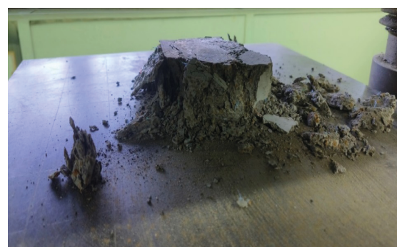
Рис. 9. Разрушение образца после испытаний, расхождение трещин от середины
