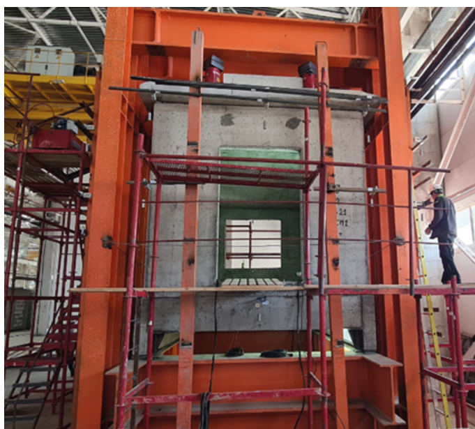
Рис. 1. Общий вид испытательного стенда с объемным блоком (фото авторов) Fig. 1. General view of the test bench with a volumetric block (photo by the authors)
