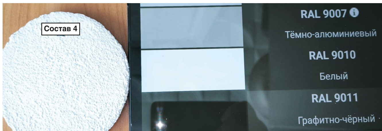
Рис. 6. Фото штукатурки «СПАДАР СК-450», модифицированной микрокальцитом и оксидом титана. Цвет по RAL – 9010, белый Fig. 6. Photo of the “SPADAR SK-450” plaster modified with microcalcite and titanium oxide. The color according to RAL is 9010, white
