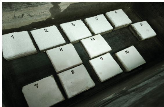
Рис. 3. Фото подготовки исследуемых образцов (погружение в воду для водонасыщения газобетона) Fig. 3. Photos of the preparation of the studied samples (immersion in water for water saturation of aerated concrete)
