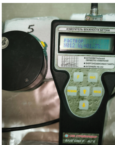
Рис. 6. Измерение влажности поверхности штукатурного покрытия исследуемых образцов влагомером МГ4 Fig. 6. Measuring the moisture content of the plaster coating surface of the studied samples with MG4 moisture meter
