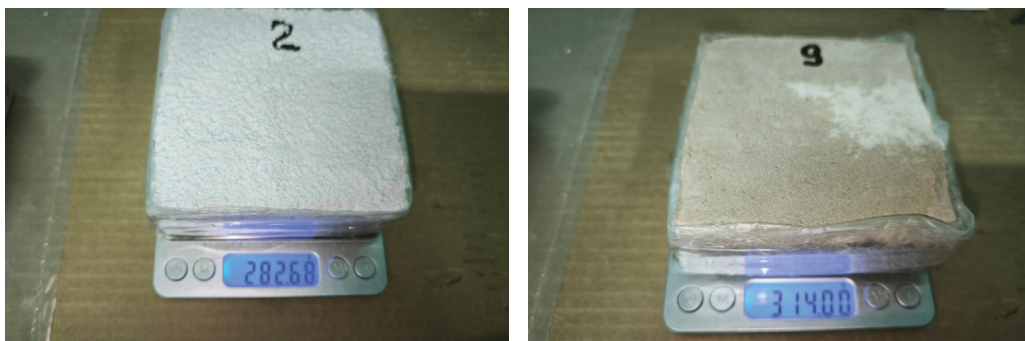
Рис. 5. Фото контрольных взвешиваний образцов. Образец 9 со штукатуркой ФВШ визуально увлажнен Fig. 5. Photos of control weighings of samples. Sample 9 with FLP plaster is visually moistened
