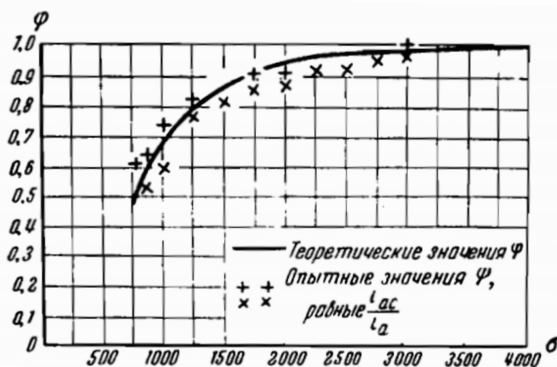
Рис. 2. Теоретические и опытные значения коэффициента \Psi_s для испытанных балок [2]
