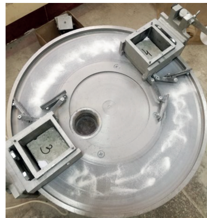
Рис. 2. Испытательный круг ЛКИ-3, процесс испытания образцов на истираемость Fig. 2. LKI-3 test circle, the process of testing of the samples for abrasability
