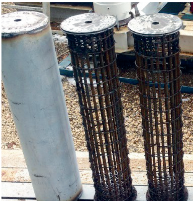
Рис. 1. Общий вид образцов первой серии моделей СО в процессе изготовления
