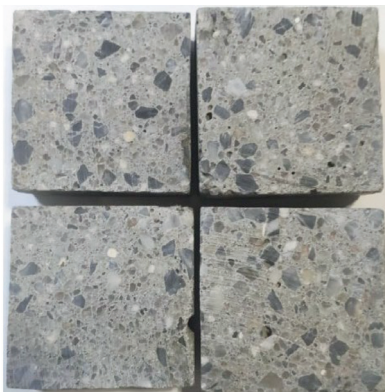
Рис. 3. Образцы бетона после испытаний на истираемость (слева направо: общий вид испытанных образцов, вид с торца, укрупненный вид со следами шлифовк) Fig. 3. Concrete samples after abrasability tests (from left to right: general view of the tested samples, end face view, enlarged view with traces of grinding)
