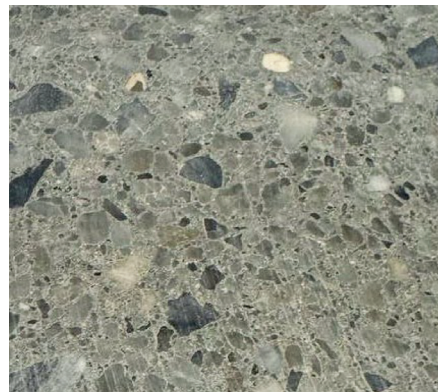
Рис. 3. Образцы бетона после испытаний на истираемость (слева направо: общий вид испытанных образцов, вид с торца, укрупненный вид со следами шлифовк) Fig. 3. Concrete samples after abrasability tests (from left to right: general view of the tested samples, end face view, enlarged view with traces of grinding)
