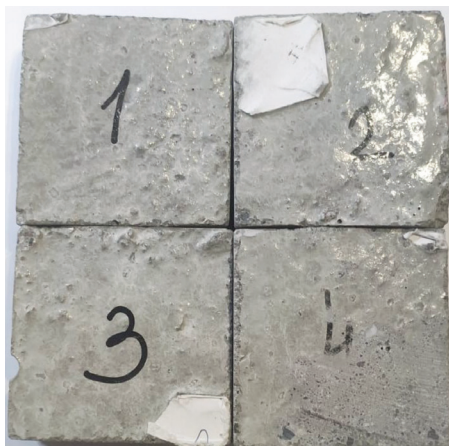
Рис. 1. Бетонные образцы до испытаний на истираемость Fig. 1. Concrete samples before abrasability tests
