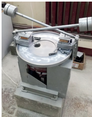
Рис. 2. Испытательный круг ЛКИ-3, процесс испытания образцов на истираемость Fig. 2. LKI-3 test circle, the process of testing of the samples for abrasability
