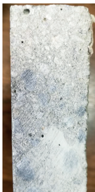
Рис. 3. Образцы бетона после испытаний на истираемость (слева направо: общий вид испытанных образцов, вид с торца, укрупненный вид со следами шлифовк) Fig. 3. Concrete samples after abrasability tests (from left to right: general view of the tested samples, end face view, enlarged view with traces of grinding)
