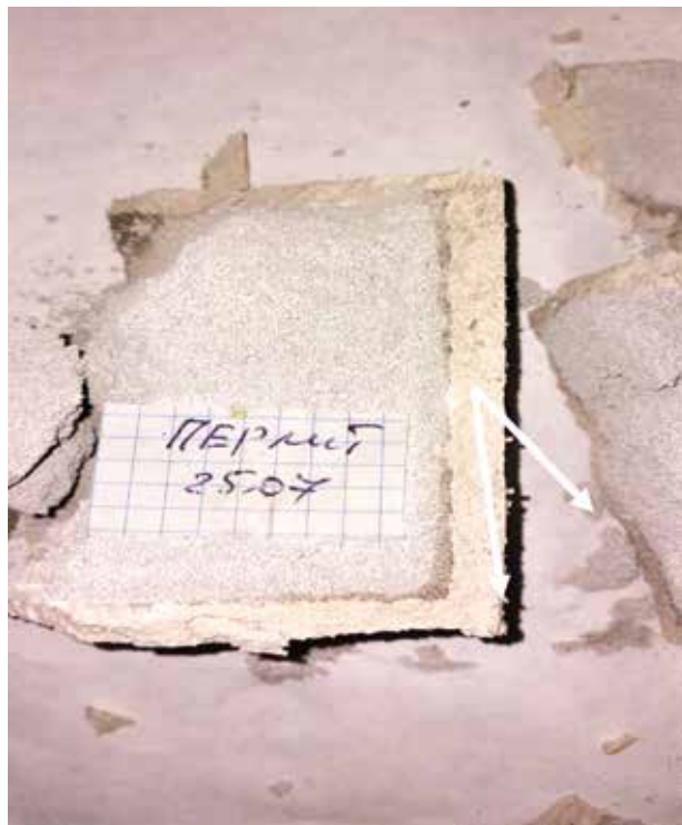
Рис. 9. Фрагменты образца из серии 4, обмазанного легкой штукатурной смесью на основе перлитового песка, после выдерживания 90 минут в воде. Вода прошла сквозь тело штукатурки и просочилась на глубину до 2,0 мм в тело газобетонного образца
