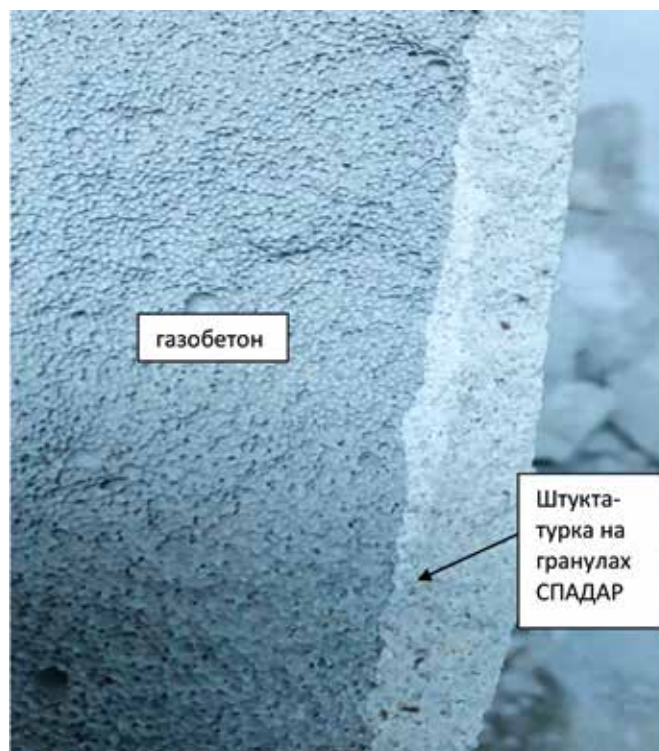
Рис. 5. Фрагмент образца из серии 2, обмазанного легкой штукатурной смесью на основе пенокерамических гранул «СПАДАР», после выдерживания на протяжении 90 минут в воде. Вода проникла в тело газобетона на 0,2 мм
