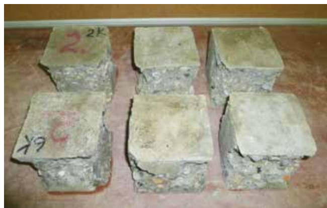
Рис. 11. Общий вид образцов из бетона на основе гранитного щебня с природным песком (а) и образцов бетона на основе рециклингового щебня с природным песком (б) после испытаний на морозостойкость Fig. 11. General view of concrete samples based on granite crushed stone with natural sand (a) and concrete samples based on recycled crushed stone with natural sand (b) after frost resistance tests
