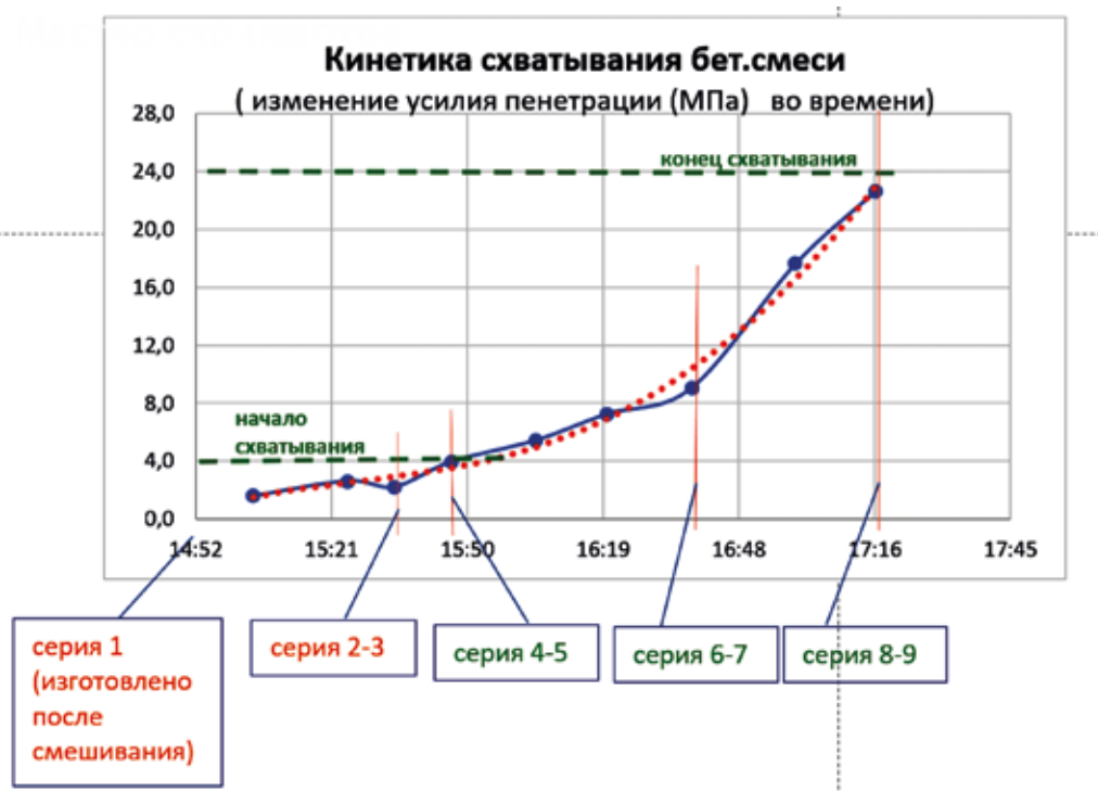
Рис. 7. Кинетика процесса схватывания бетонной смеси с указанием моментов вибровоздействия на основные серии образцов Fig. 7. Kinetics of the setting of the concrete mixture process with indication of the moments of vibration impact on the main series of samples
