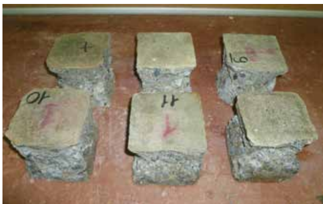
Рис. 11. Общий вид образцов из бетона на основе гранитного щебня с природным песком (а) и образцов бетона на основе рециклингового щебня с природным песком (б) после испытаний на морозостойкость Fig. 11. General view of concrete samples based on granite crushed stone with natural sand (a) and concrete samples based on recycled crushed stone with natural sand (b) after frost resistance tests
