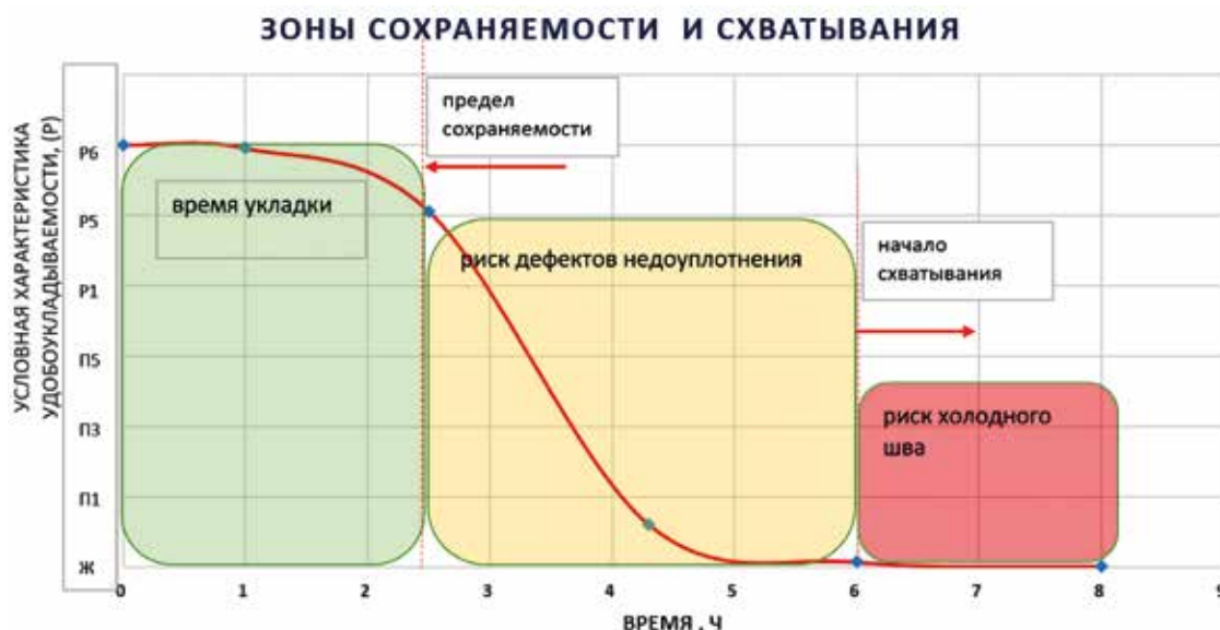
Рис. 2. Кинетика перехода от стадии сохраняемости удобоукладываемости смеси к стадии начала схватывания Fig. 2. Kinetics of the transition from the mixture workability preservation stage to the stage of the setting beginning
