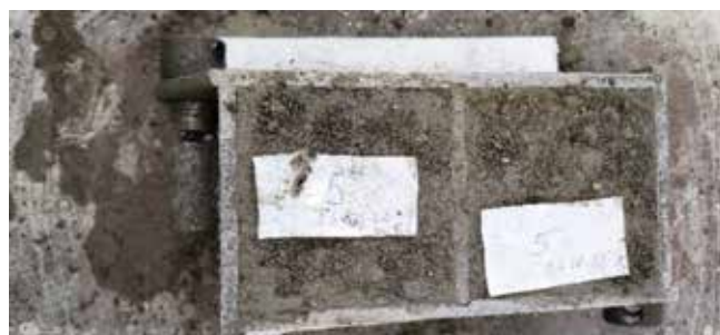
Рис. 8. Повторная вибрация смеси в форме с помощью вибропалки. Состояние формованных образцов при вибрации в процессе схватывания Fig. 8. Repeated vibration of the mixture in the mold using a vibrating mace. State of molded samples with vibration during setting
