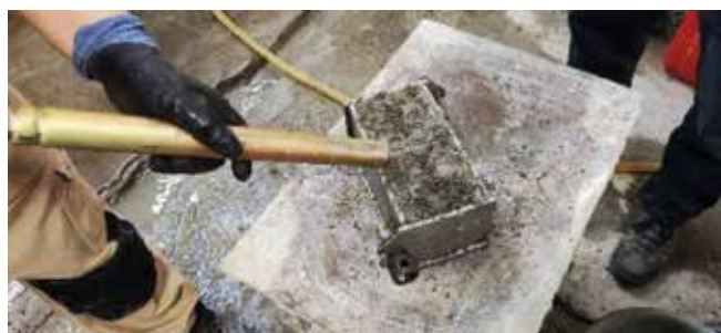
Рис. 8. Повторная вибрация смеси в форме с помощью вибропалки. Состояние формованных образцов при вибрации в процессе схватывания Fig. 8. Repeated vibration of the mixture in the mold using a vibrating mace. State of molded samples with vibration during setting
