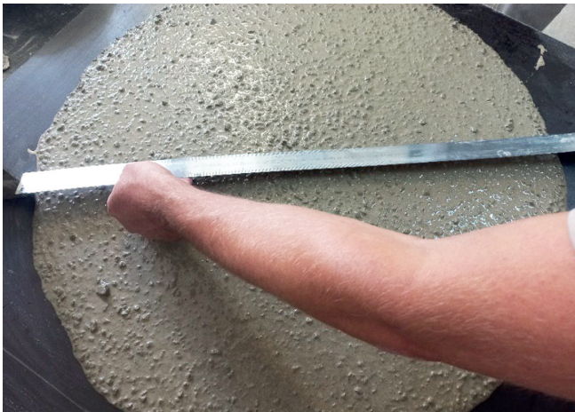
Рис. 1. Расплав мелкозернистой самоуплотняющейся бетонной смеси на основе природных щебня и песка с минеральной добавкой из мелкой фракции вторичного (рециклингового) песка при определении ее удобоукладываемости
