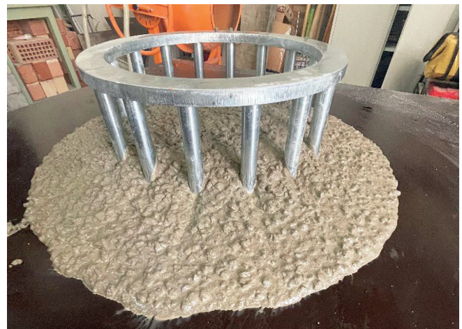
Рис. 4. Определение текучести мелкозернистой самоуплотняющейся бетонной смеси на основе рециклинговых (вторичных) щебня и песка с минеральной добавкой из мелкой фракции вторичного (рециклингового) песка
