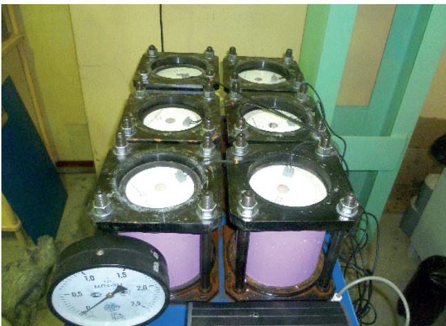
Рис. 9. Общий вид образцов из мелкозернистых самоуплотняющихся бетонов на основе природных и рециклинговых (вторичных) щебня и песка с минеральной добавкой из мелкой фракции вторичного (рециклингового) песка в процессе их испытаний на водонепроницаемость
