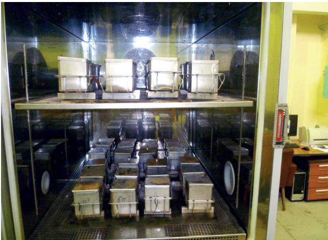
Рис. 7. Определение морозостойкости образцов из мелкозернистых самоуплотняющихся бетонов на основе природных и рециклинговых (вторичных) щебня и песка с минеральной добавкой из мелкой фракции вторичного (рециклингового) песка
