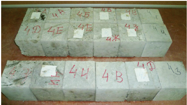
Рис. 6. Общий вид образцов-кубов 100 × 100 × 100 мм для определения основных физико-механических характеристик мелкозернистых самоуплотняющихся бетонов на основе рециклинговых (вторичных) щебня и песка с минеральной добавкой из мелкой фракции вторичного (рециклингового) песка Fig. 6. General view of cube samples 100 × 100 × 100 mm to determine the basic physical and mechanical characteristics of fine-grained self-compacting concrete based on secondary (recycled) crushed stone and sand with a mineral additive of the fine fraction of secondary (recycled) sand
