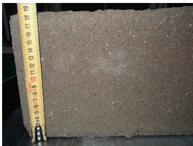
Рис. 1. Стеновой бетонный камень 390 × 188 × 90 мм, контроль высоты образца
