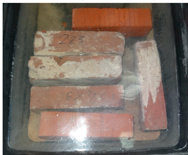
Рис. 3. Выдержка во влажной среде образцов кладочных изделий
