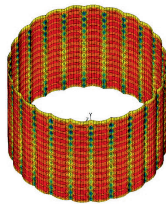
Погонные изгибающие моменты в горизонтальном направлении \text{Min } M_r = -13.8588 \text{ кНм/м} , \text{Max } M_r = 59.6758 \text{ кНм/м}
