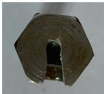
Рис. 4. Захватное приспособление для испытания дюбеля на вырыв, устанавливаемое в прибор ПОС-50 Fig. 4. Gripping device for testing the dowel for pullout, installed in the POS-50 device
