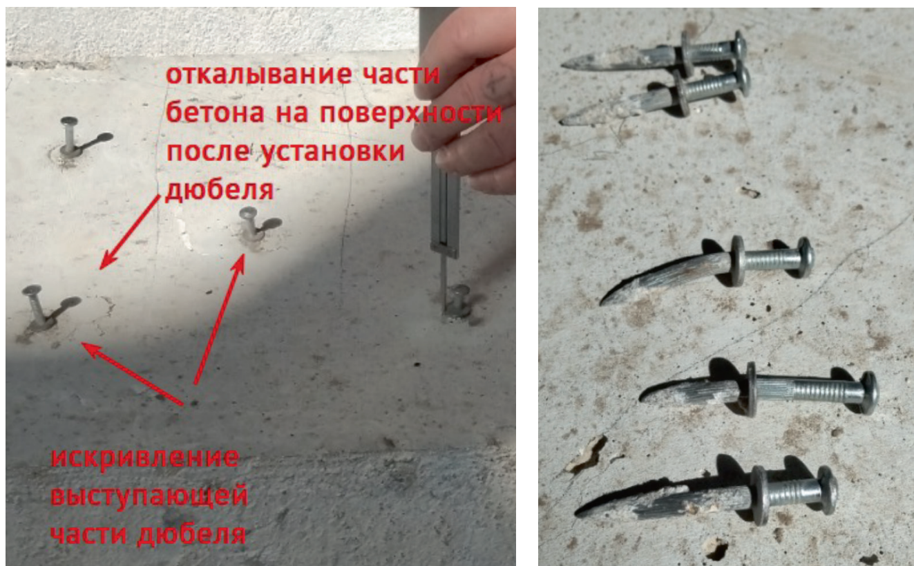
Рис. 5. Искривление выступающей (а) и заглубленной (б) части дюбеля Fig. 5. Curvature of the protruding (a) and recessed (b) parts of the dowel
