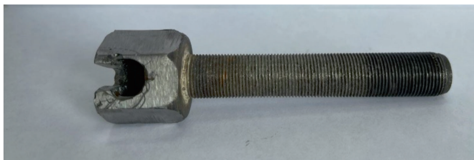
Рис. 4. Захватное приспособление для испытания дюбеля на вырыв, устанавливаемое в прибор ПОС-50 Fig. 4. Gripping device for testing the dowel for pullout, installed in the POS-50 device
