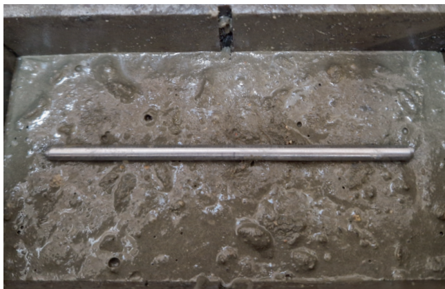
Рис. 2. Общий вид арматурного стержня и его расположения в образце-призме с размерами 70 \times 70 \times 140 мм
