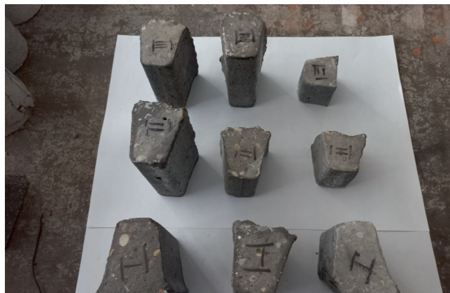
Рис. 5. Общий вид подготовленных для проведения исследований образцов бетона, возраст которых составляет около 70 лет, с карбонизированным защитным слоем бетона
