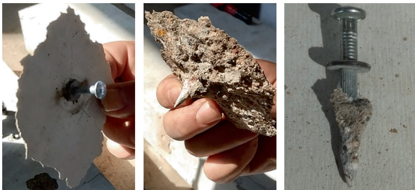
Рис. 1. Конус выкалывания и вид дюбеля после испытания на вырыв Fig. 1. The chipping cone and the view of dowel after the pullout test
