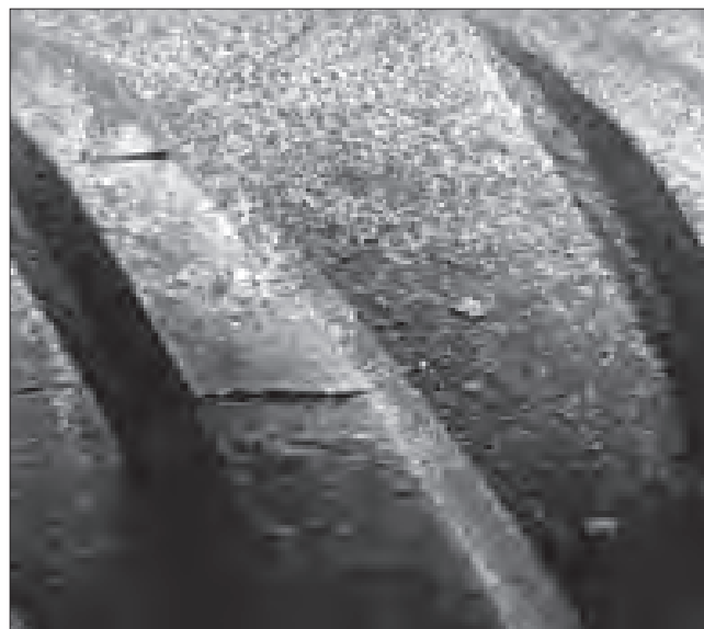
Рис. 1. Общий вид трещин в поперечных ребрах арматурного проката диаметром 40 мм
