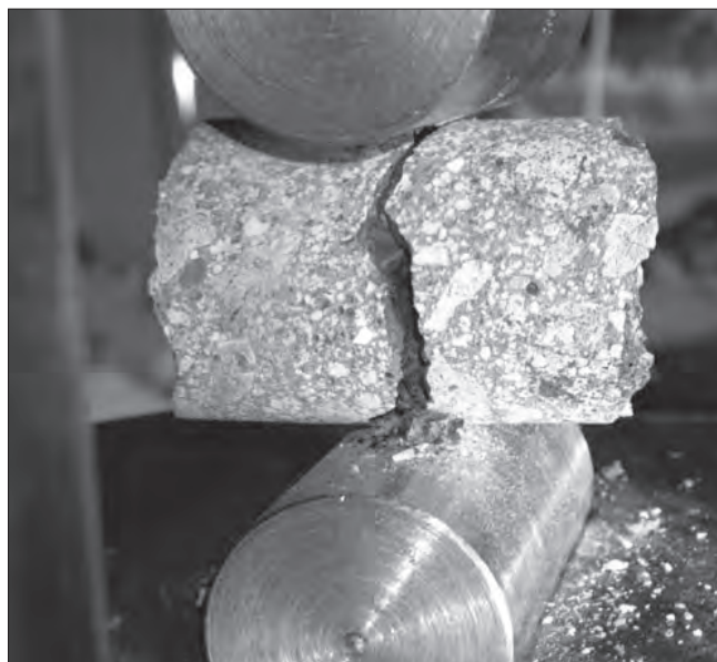
Рис. 1. Пример испытанного образца на растяжение при раскалывании по предлагаемой схеме двухточечного приложения нагрузки Fig. 1. Example of a split tensile test specimen using the proposed two-point load application scheme
