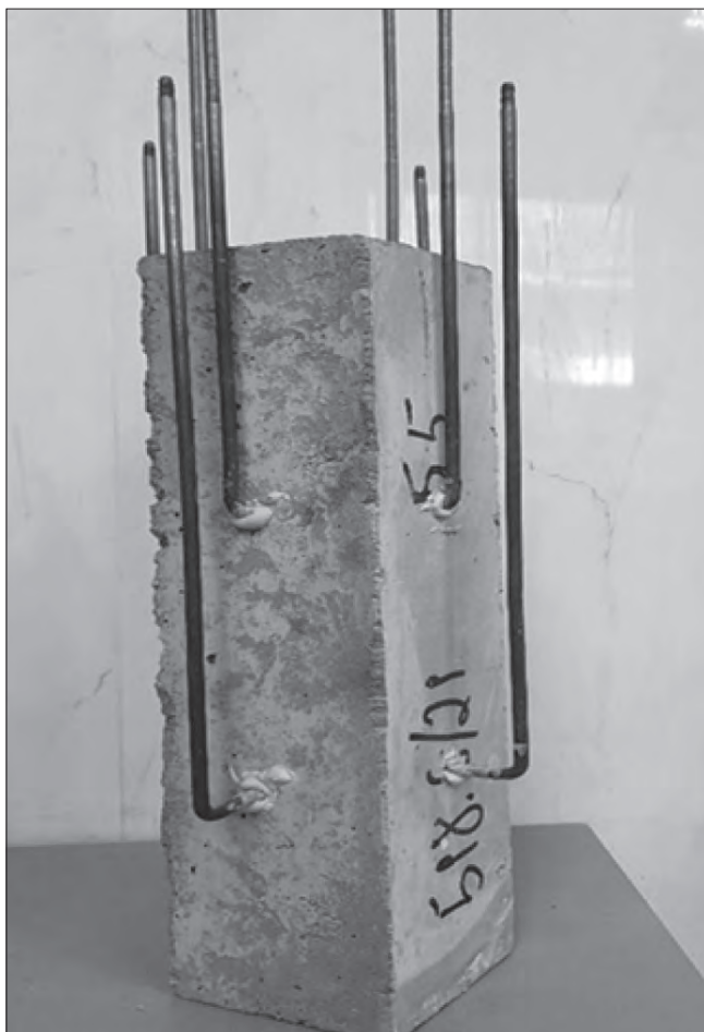
Рис. 1. Вид образца бетона с установленными выносными удлинителями, подготовленного для испытания на осевое сжатие с построением диаграмм деформирования « \sigma – \varepsilon » при нагреве
