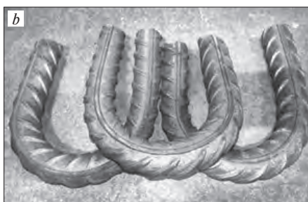
Рис. 2. Образцы после испытаний: а — при растяжении; б — при изгибе Fig. 2. Samples after testing: a — tensile testing; b — bending
