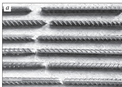
Рис. 2. Образцы после испытаний: а — при растяжении; б — при изгибе Fig. 2. Samples after testing: a — tensile testing; b — bending
