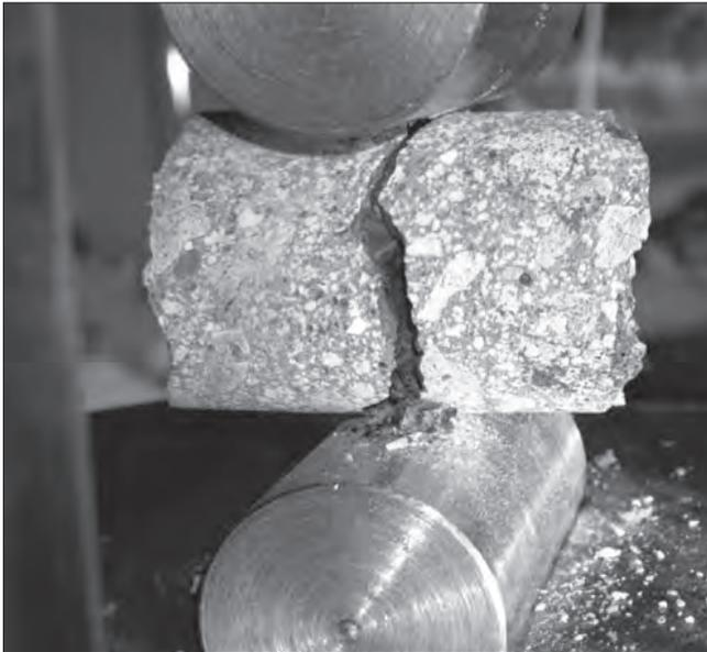
**Рис. 1.** Пример испытанного образца на растяжение при раскалывании по предлагаемой схеме двухточечного приложения нагрузки
