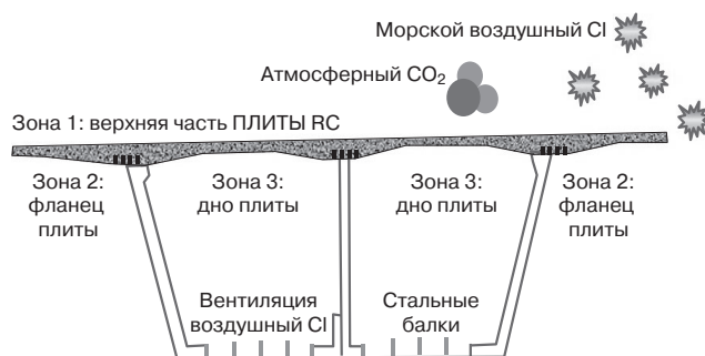
Рис. 5. Поперечное сечение композитных плит и различные условия экспозиции Fig. 5. Cross-section of composite plates and various exposure conditions
