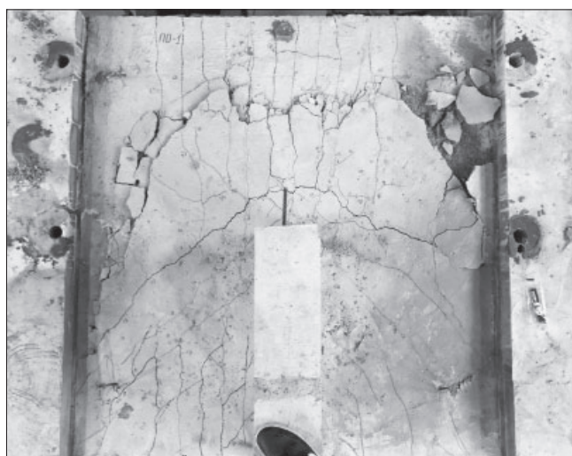
Рис. 3. Схема трещин на верхней поверхности плит. Образец ПО-1 Fig. 3. Diagram of cracks on the upper surface of the plates. PO-1 prototype
