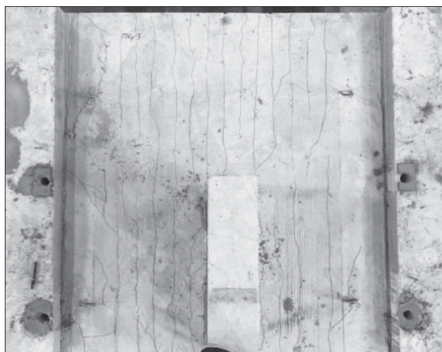
Рис. 8. Схема трещин на верхней поверхности плит. Образец ПКр-3
