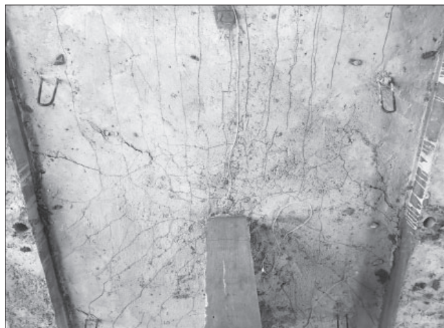
Рис. 6. Схема трещин на верхней поверхности плит. Образец ПКр-1
