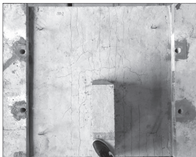
Рис. 4. Схема трещин на верхней поверхности плит. Образец ПО-2 Fig. 4. Diagram of cracks on the upper surface of the plates. PO-2 prototype
