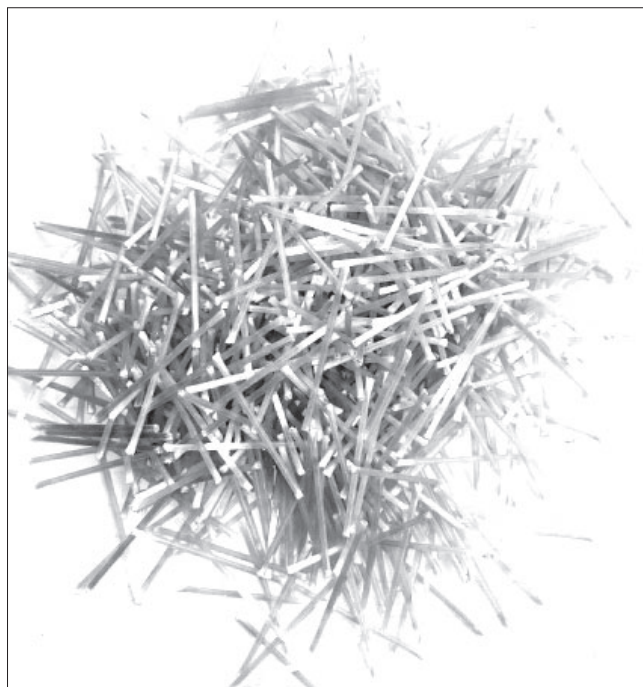
Рис. 1. Стеклопластиковая макрофибра ФСК Fig. 1. FSK fiberglass macrofiber
