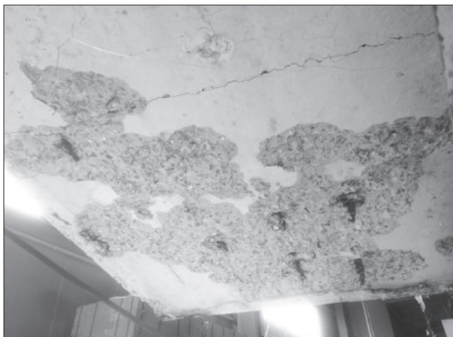
Рис. 10. Обширные участки взрывообразного разрушения обогреваемой поверхности плит из фибробетона с оголением АСК Fig. 10. Extensive areas of explosive destruction of the heated surface of fiber-reinforced concrete slabs with exposure of ASC
