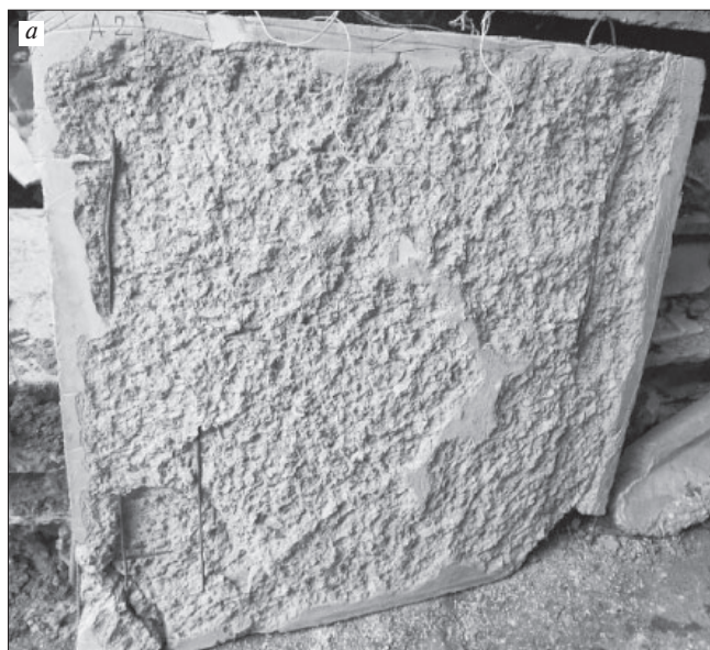
Рис. 6. Характерный вид бетонных поверхностей тонких малогабаритных плит из обычного тяжелого бетона (а) и фибробетона с добавкой ФСК (б) после огневого испытания
