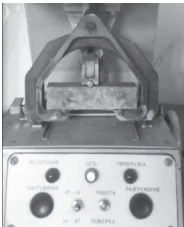
Рис. 1. Испытание образцов-балочек при изгибе
