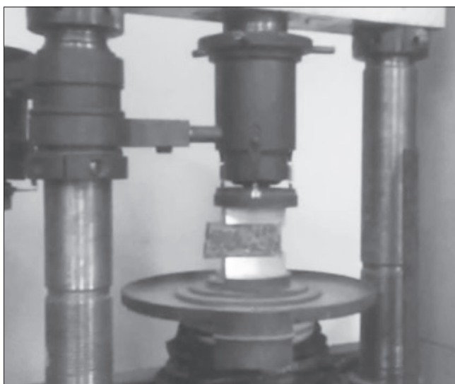
Рис. 3. Испытание образцов-кубов при сжатии Fig. 3. Compression test of cube samples
