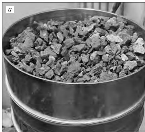
Рис. 3. Рециклинговый щебень из боя керамического кирпича: а — полученный из кирпичной кладки с раствором; б — полученный из кирпича без раствора
