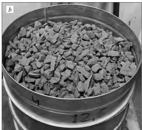
Рис. 3. Рециклинговый щебень из боя керамического кирпича: а — полученный из кирпичной кладки с раствором; б — полученный из кирпича без раствора
