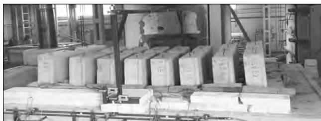
Рис. 4. Характерный вид плит с АСК на начальной стадии огневого испытания
