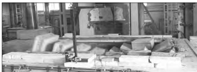
Рис. 5. Вид плит с АСК после обрушения
