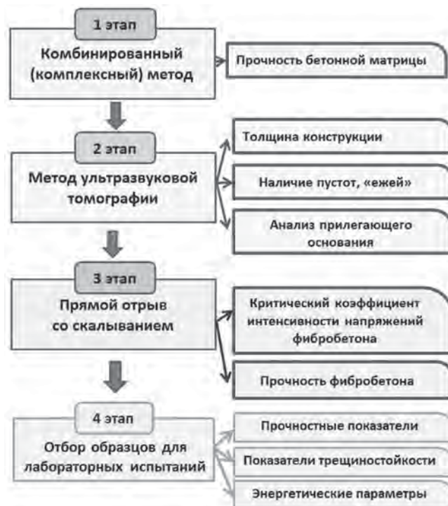
Рис. 1. Блок-схема методики контроля качества наноприобетона в конструкции
