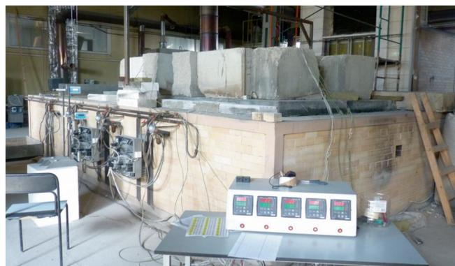
**Рис. 3.** Характерный вид плит серии 6 под нагрузкой перед огневым испытанием
