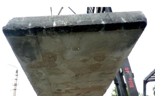
**Рис. 4.** Вид обогреваемой поверхности плиты серии 1 (6,75 % микрокремнезема в ВБ) после огневого испытания
