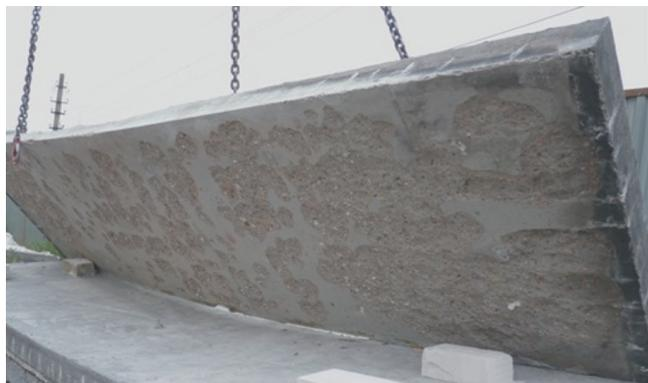
**Рис. 6.** Вид обогреваемой поверхности плиты серии 6 (9 % микрокремнезема в БВ) после огневого испытания. Класс бетона – В80
