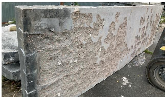
**Рис. 7.** Вид обогреваемой поверхности плиты серии 4 (9 % микрокремнезема в БВ) после огневого испытания. Класс бетона – В100
