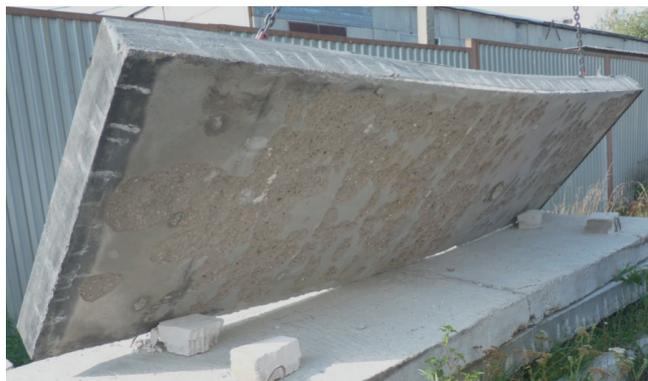
**Рис. 5.** Вид обогреваемой поверхности плиты серии 2 (9 % микрокремнезема в БВ) после огневого испытания. Класс бетона – В60
