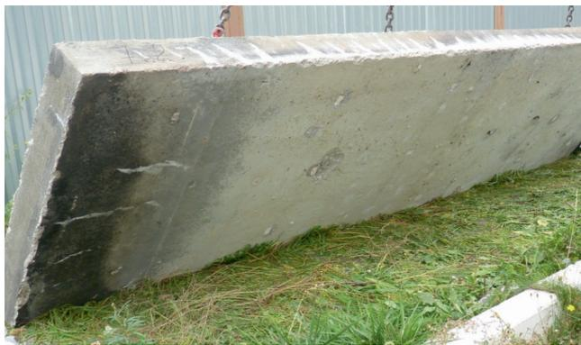
**Рис. 8.** Вид обогреваемой поверхности плиты контрольной серии 7 (из обычного тяжелого бетона) после огневого испытания. Класс бетона – В30. Присутствуют два локальных скола бетона
