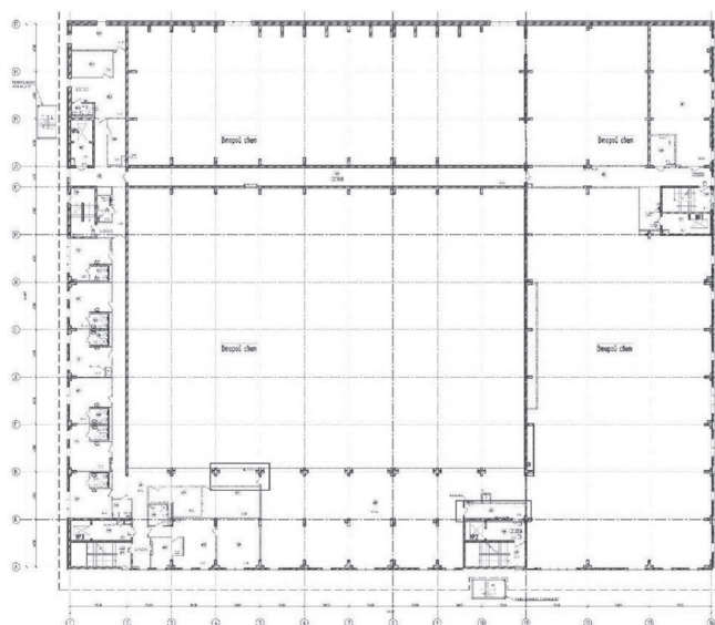
Рис. 2. План несущих конструкций 7-го этажа (стальные фермы условно не показаны) Fig. 2. The plan of the bearing structures of the 7th floor (steel trusses are conditionally not shown)
