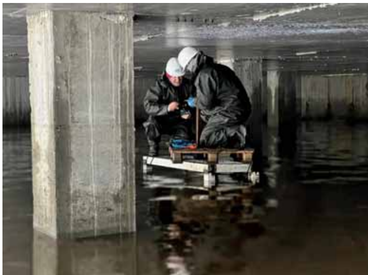
Рис. 6. Процесс монтажа и индикатор часового типа, установленный по центру СФБ плиты в загружаемой ячейке (автор фото Маслов П.С.)
