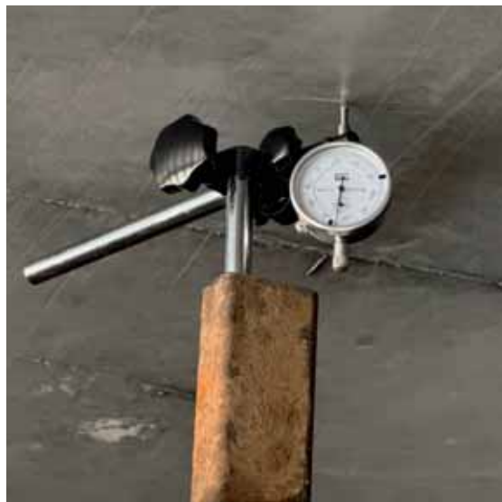
Рис. 6. Процесс монтажа и индикатор часового типа, установленный по центру СФБ плиты в загружаемой ячейке (автор фото Маслов П.С.)
