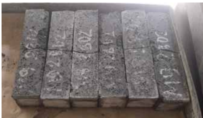
Рис. 8. Внешний вид образцов после испытания предельной разрушающей нагрузкой на изгиб
