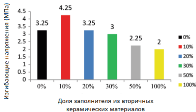
Рис. 4. Влияние вторичных керамических материалов на комбинированную прочность бетона при изгибе и кручении на 28 сутки [7]
