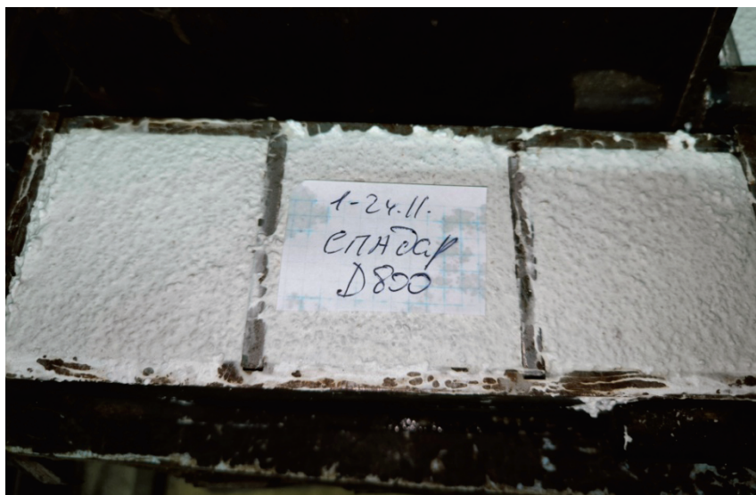
Рис. 1. Фото изготовления образцов тестируемых составов легкой штукатурки Fig. 1. Photos of the production of samples of tested light plaster compositions
