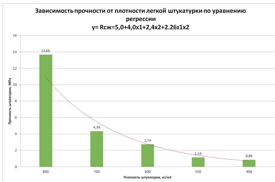
Рис. 3. График зависимости «прочность–плотность» легкой штукатурки на пенокерамических гранулах «СПАДАР», описанная формулой регрессии Fig. 3. The graph of the strength-density relationship of light plaster on SPADAR foam granules, described by the regression formula
