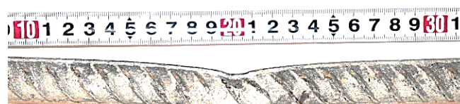
Рис. 4. Стержень-упор модели М5 (арматура \varnothing 20 А500С) Fig. 4. Reinforced concrete dowels for model M5 (reinforcement \varnothing 20 А500С)
