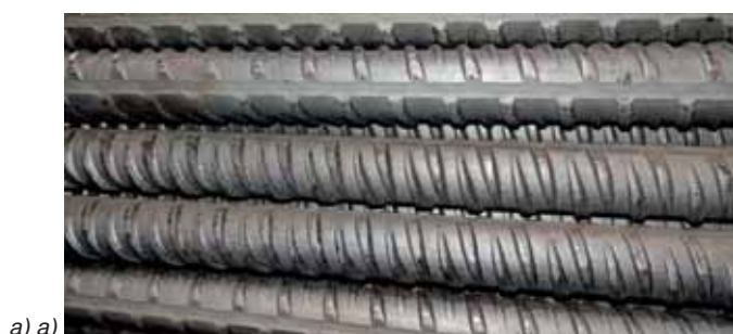
Рис. 31. Профиль арматуры с двухзаходным винтообразным расположением по поверхности серповидных рёбер:
