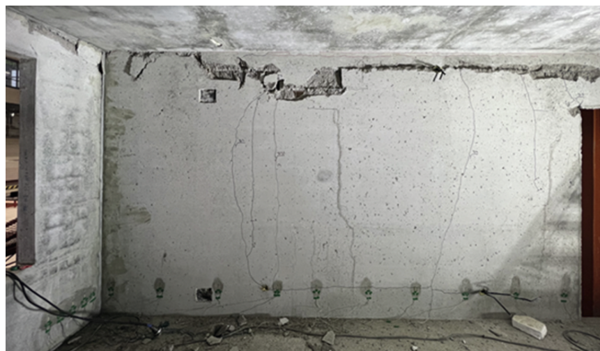
Рис. 8. Разрушение стен объемного блока № 2 Fig. 8. The destruction of the walls of the volumetric block No. 2
