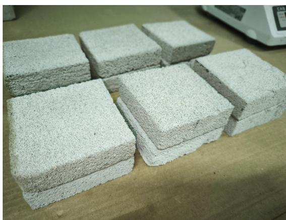
**Рис. 1.** Фото образцов газобетона, выпиленных из блока
