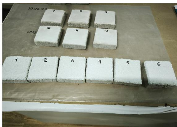
**Рис. 2.** Фото образцов газобетона, покрытых слоем исследуемых штукатурных смесей
