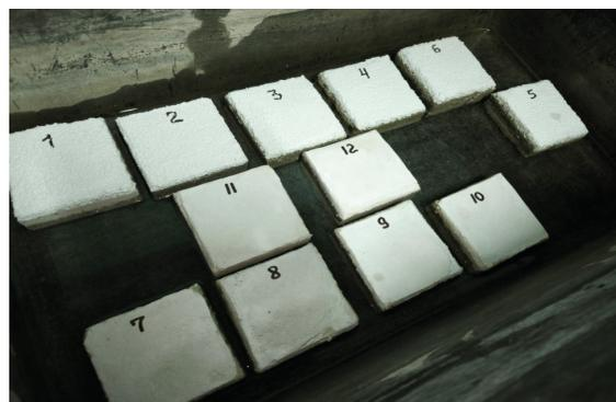
**Рис. 3.** Фото подготовки исследуемых образцов (погружение в воду для водонасыщения газобетона)
