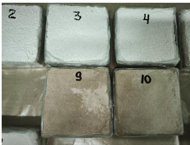
**Рис. 9.** Фото исследуемых образцов. Сверху образцы со штукатуркой «СПАДАР СК-450», снизу со штукатуркой ФВШ
