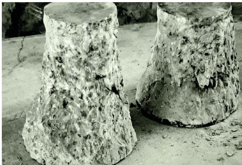
Рис. 6. Выдавленная сердцевина при разрушении образца Fig. 6. The core extruded during the sample destruction
