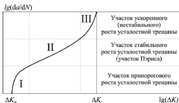
Рис. 6. Кинетическая диаграмма разрушения стандартного бетона [21]
