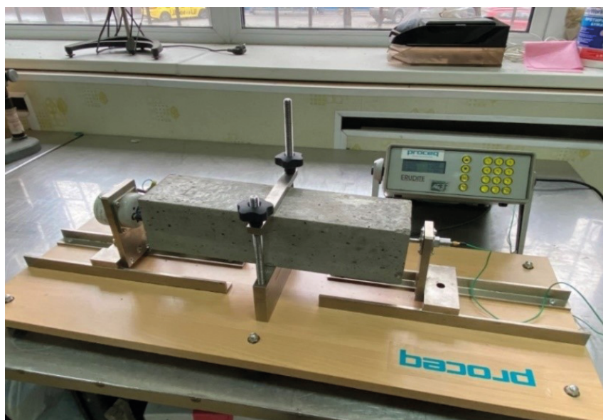
Рис. 2. Определение динамического модуля упругости легких бетонов Fig. 2. Determination of the dynamic modulus of elasticity of lightweight concrete
