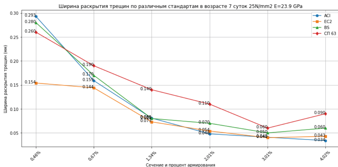
Рис. 7. Ширина раскрытия трещин по различным стандартам в возрасте 7 суток 25 Н/мм 2 , E = 23,9 ГПа Fig. 7. The crack opening width according to various standards at the age of 7 days 25 N/mm 2 , E = 23.9 GPa
