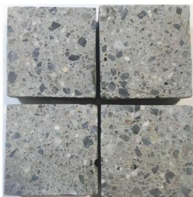
Рис. 3. Образцы бетона после испытаний на истираемость (слева направо: общий вид испытанных образцов, вид с торца, укрупненный вид со следами шлифовки) Fig. 3. Concrete samples after abrasability tests (from left to right: general view of the tested samples, end face view, enlarged view with traces of grinding)
