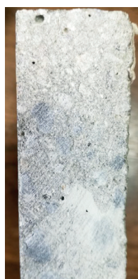
Рис. 3. Образцы бетона после испытаний на истираемость (слева направо: общий вид испытанных образцов, вид с торца, укрупненный вид со следами шлифовки) Fig. 3. Concrete samples after abrasability tests (from left to right: general view of the tested samples, end face view, enlarged view with traces of grinding)
