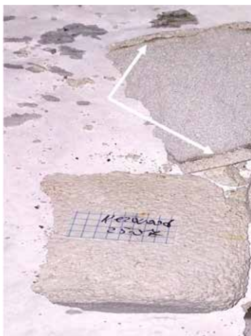
Рис. 8. Фрагменты образца из серии 3, обмазанного легкой штукатурной смесью на основе пенокерамических гранул «KERWOOD», после выдерживания на протяжении 90 минут в воде. Вода прошла сквозь тело штукатурки и просочилась на глубину до 0,5 мм в тело газобетонного образца
