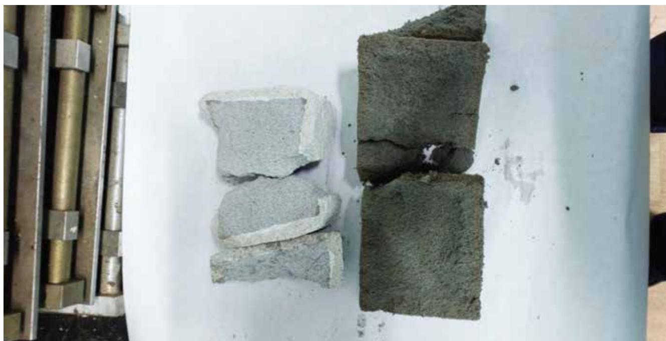
Рис. 6. Фрагменты образца из серии 2, обмазанного легкой штукатурной смесью на основе пенокерамических гранул «СПАДАР», после выдерживания на протяжении 90 минут в воде (слева) и контрольного образца из серии 1 (справа).
