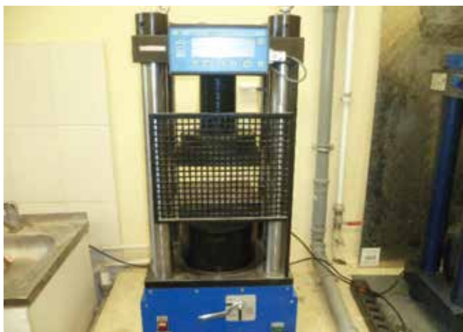
Рис. 2. Общий вид гидравлического пресса для определения прочности бетонов Fig. 2. General view of the hydraulic press for determining the strength of concrete
