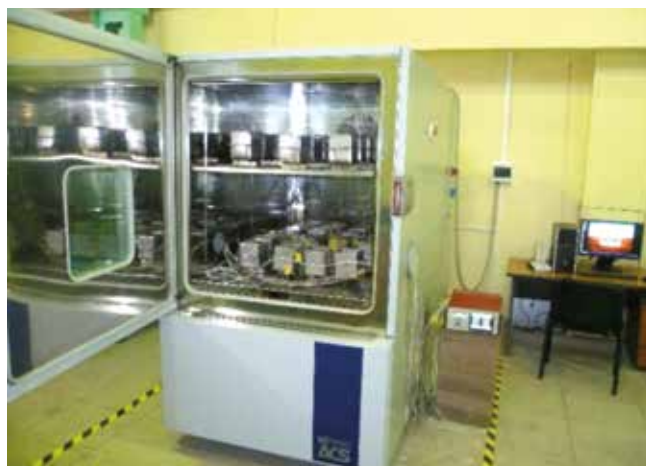
Рис. 3. Общий вид климатической камеры для определения морозостойкости бетонов Fig. 3. General view of the climate chamber for determining the frost resistance of concrete
