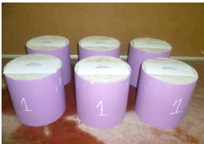
Рис. 6. Общий вид образцов бетона на основе гранитного щебня с природным песком до и в процессе испытаний на водонепроницаемость
