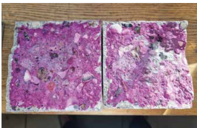
Рис. 8. Общий вид образцов бетона на основе гранитного (а) и рециклингового (б) щебня с природным песком после испытания на диффузионную проницаемость для углекислого газа
