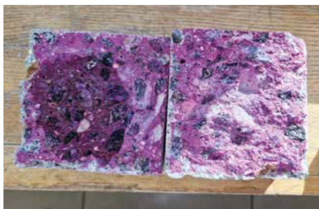
Рис. 8. Общий вид образцов бетона на основе гранитного (а) и рециклингового (б) щебня с природным песком после испытания на диффузионную проницаемость для углекислого газа
