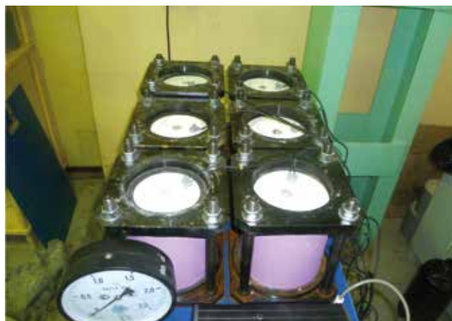
Рис. 6. Общий вид образцов бетона на основе гранитного щебня с природным песком до и в процессе испытаний на водонепроницаемость
