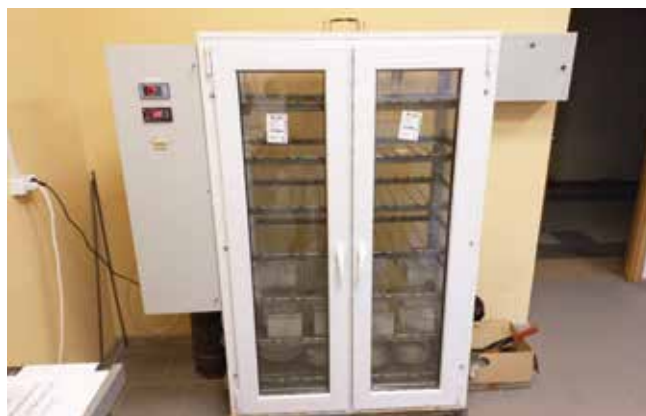
Рис. 5. Общий вид газоанализатора диоксида углерода для определения диффузионной проницаемости для углекислого газа бетонов Fig. 5. General view of a carbon dioxide gas analyzer for determining the diffusion permeability of concrete for carbon dioxide
