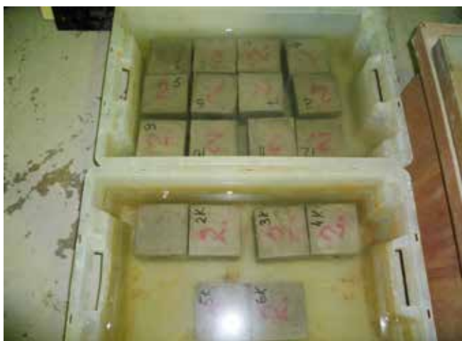
Рис. 10. Определение морозостойкости образцов бетона на основе рециклингового щебня с природным песком Fig. 10. Determination of frost resistance of concrete samples based on recycled crushed stone with natural sand
