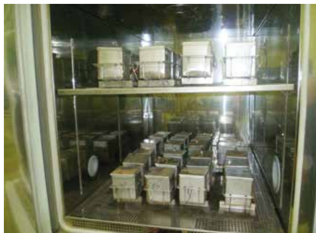
Рис. 9. Определение морозостойкости образцов бетона на основе гранитного щебня с природным песком Fig. 9. Determination of frost resistance of concrete samples based on granite rubble with natural sand
