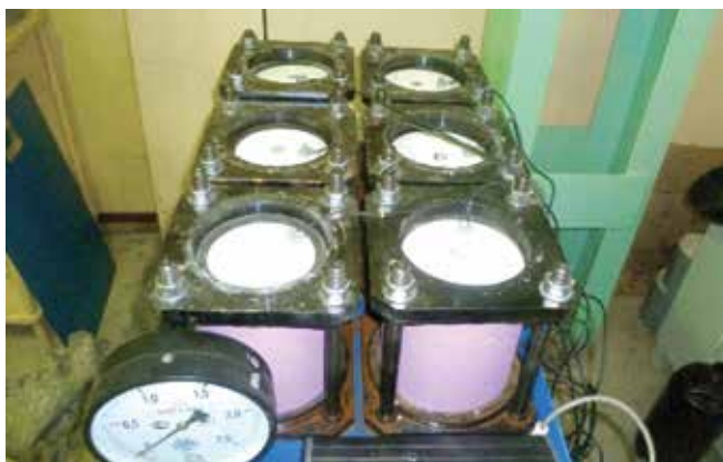
Рис. 4. Общий вид установки для определения водонепроницаемости бетонов Fig. 4. General view of the installation for determining the water resistance of concrete
