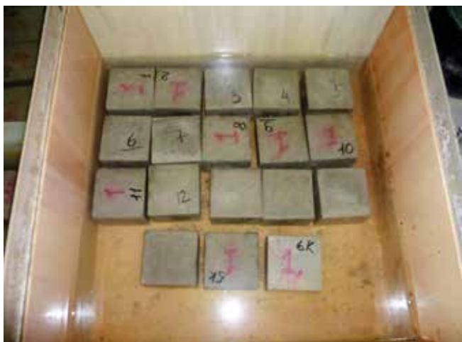
Рис. 9. Определение морозостойкости образцов бетона на основе гранитного щебня с природным песком Fig. 9. Determination of frost resistance of concrete samples based on granite rubble with natural sand
