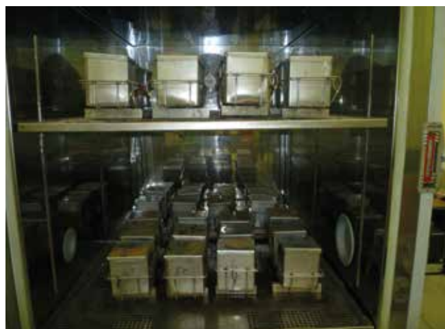
Рис. 10. Определение морозостойкости образцов бетона на основе рециклингового щебня с природным песком Fig. 10. Determination of frost resistance of concrete samples based on recycled crushed stone with natural sand
