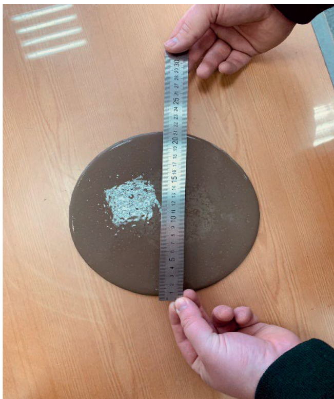
Рис. 1. Измерение диаметра расплыва цементного теста Fig. 1. Measuring the diameter of the spread of cement paste
