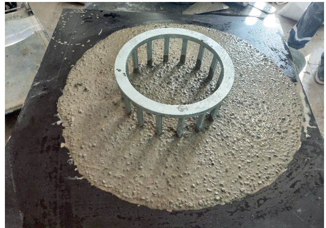
Рис. 2. Определение текучести мелкозернистой самоуплотняющейся бетонной смеси на основе природных щебня и песка с минеральной добавкой из мелкой фракции вторичного (рециклингового) песка
