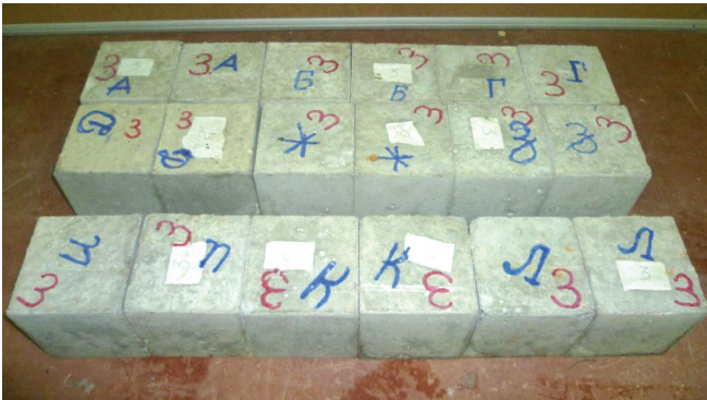
Рис. 5. Общий вид образцов-кубов 100 × 100 × 100 мм для определения основных физико-механических характеристик мелкозернистых самоуплотняющихся бетонов на основе природных щебня и песка с минеральной добавкой из мелкой фракции вторичного (рециклингового) песка Fig. 5. General view of cube samples 100 × 100 × 100 mm to determine the basic physical and mechanical characteristics of fine-grained self-compacting concrete based on natural crushed stone and sand with a mineral additive of the fine fraction of secondary (recycling) sand
