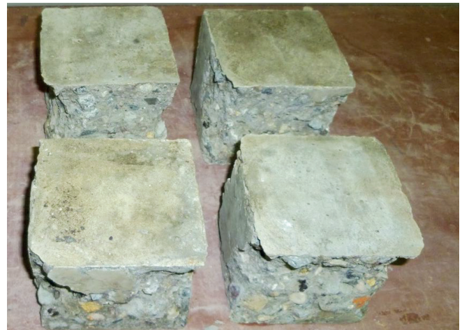
Рис. 8. Общий вид образцов из мелкозернистых самоуплотняющихся бетонов на основе природных и рециклинговых (вторичных) щебня и песка с минеральной добавкой из мелкой фракции вторичного (рециклингового) песка после их испытаний на морозостойкость
