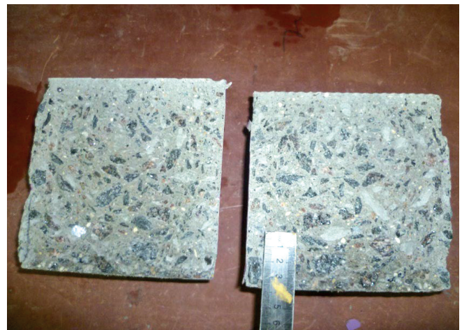
Рис. 10. Общий вид образцов из мелкозернистых самоуплотняющихся бетонов на основе природных и рециклинговых (вторичных) щебня и песка с минеральной добавкой из мелкой фракции вторичного (рециклингового) песка после их испытаний на водонепроницаемость
