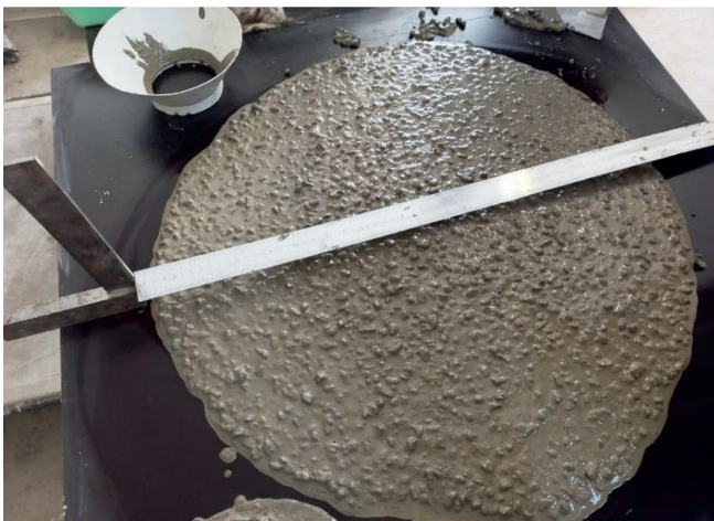
Рис. 3. Расплав мелкозернистой самоуплотняющейся бетонной смеси на основе рециклинговых (вторичных) щебня и песка с минеральной добавкой из мелкой фракции вторичного (рециклингового) песка при определении ее удобоукладываемости
