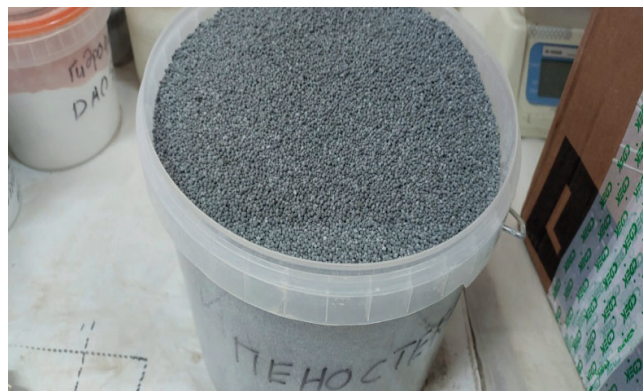
Рис. 3. Гранулированное пеностекло Fig. 3. Granular foam glass
