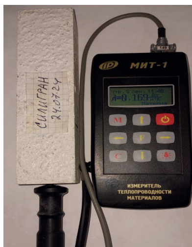
Рис. 9. Фото определения теплопроводности состава 1 легкой штукатурки с пенокерамикой «СПАДАР»
