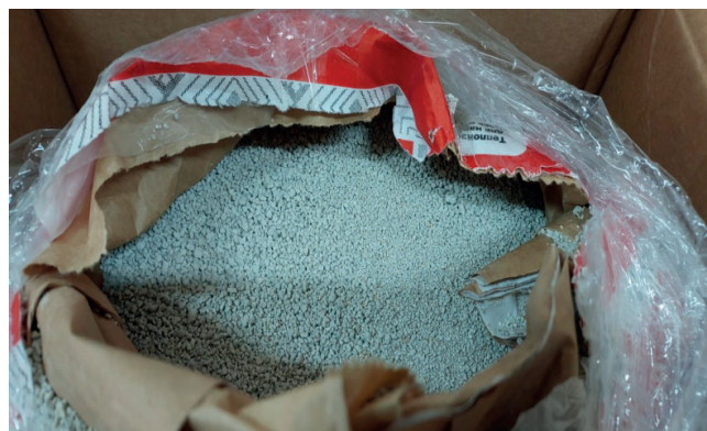
Рис. 1. Гранулы пенокерамические «СПАДАР» Fig. 1. "SPADAR" foam ceramic granules
