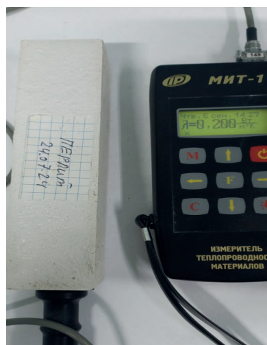
Рис. 10. Фото определения теплопроводности состава 3 легкой штукатурки с перлитом
