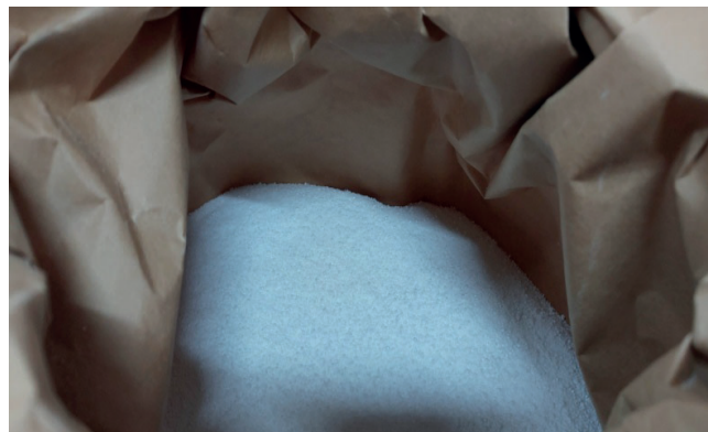
Рис. 4. Вспученный перлитовый песок Fig. 4. Expanded perlite sand
