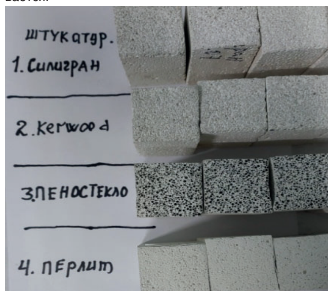
Рис. 5. Фото подготовки образцов для испытаний капиллярного водопоглощения («СИЛИГРАН» – «СПАДАР»)
