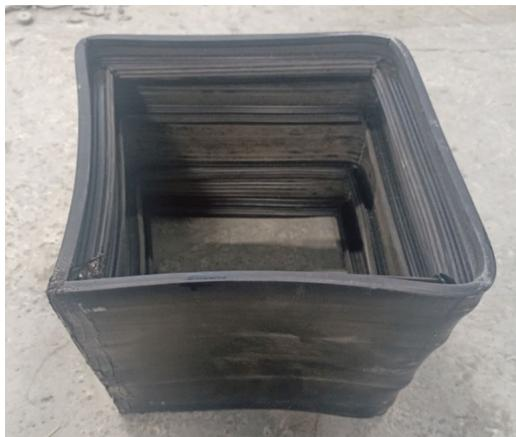
Рис. 3. Образец шпонки № 1 перед бетонированием
