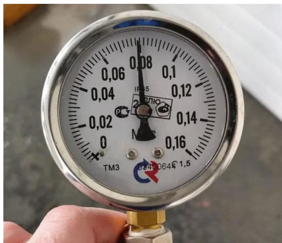
Рис. 7. Манометр для контроля давления
