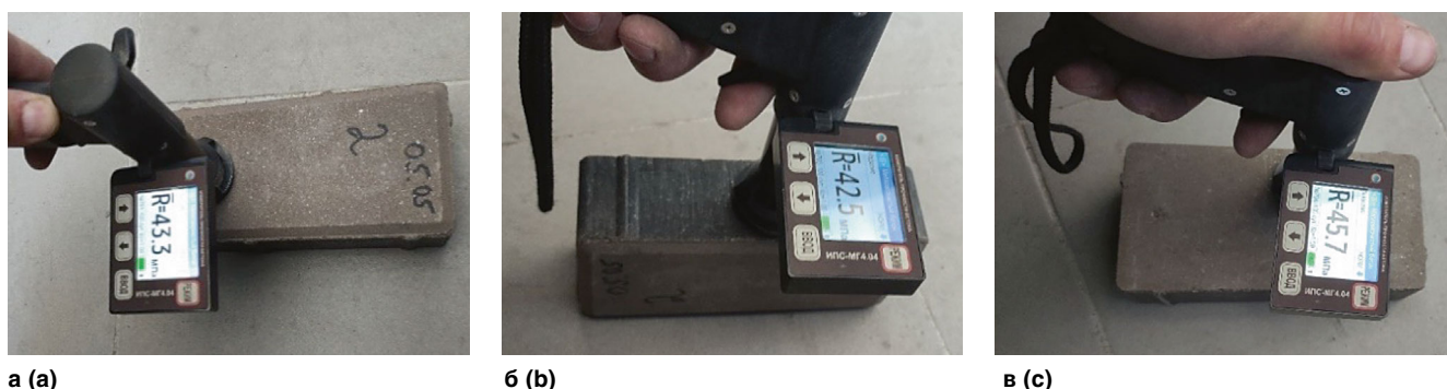
а (а) б (б) в (в) Рис. 3. Поверхностная прочность лицевой (а), боковой (б) и нижней (в) поверхностей плитки тротуарной Fig. 3. Surface strength of front (a), side (b) and bottom (c) surfaces of paving tiles
