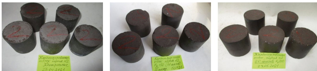
Рис. 5. Внешний вид образцов-цилиндров партии № 2 после испытания на морозостойкость (20 циклов). Внешних дефектов и повреждений образцов не наблюдается Fig. 5. The appearance of the cylinder samples of batch No. 2 after the frost resistance test (20 cycles). There are no external defects or damage to the samples found
