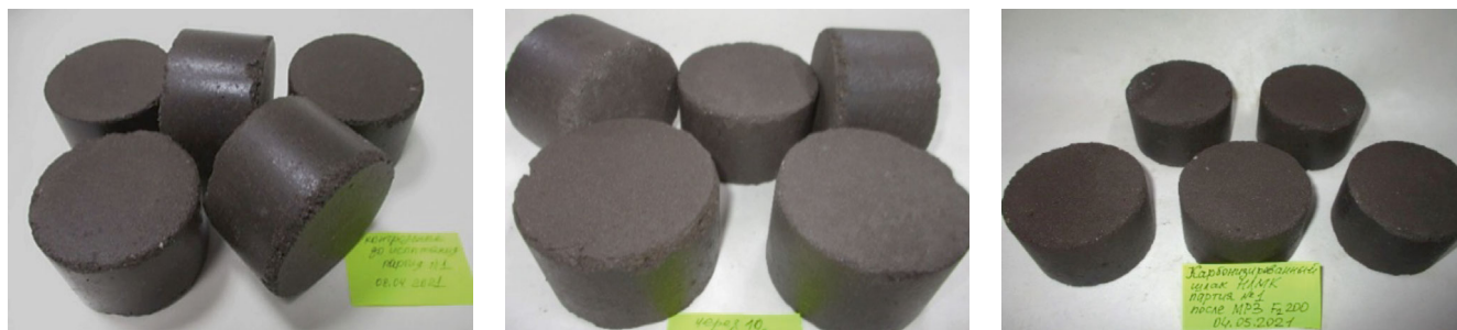
Рис. 4. Внешний вид образцов-цилиндров партии № 1 после испытания на морозостойкость (20 циклов). Внешних дефектов и повреждений образцов не наблюдается Fig. 4. The appearance of the cylinder samples of batch No. 1 after the frost resistance test (20 cycles). There are no external defects or damage of the samples found
