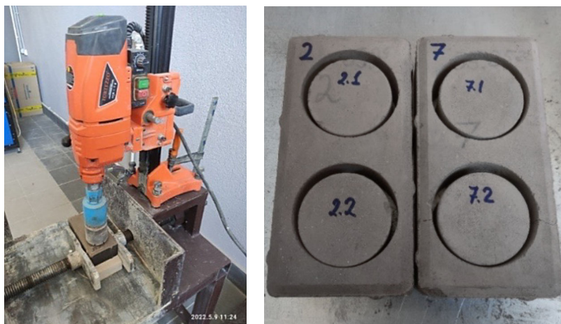
Рис. 2. Установка для выбуривания кернов Fig. 2. Cores drilling setup
