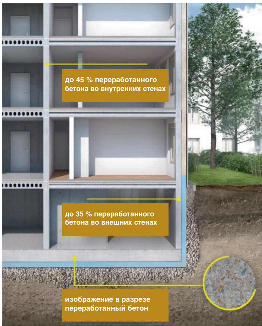
Рис. 6. Содержание переработанных бетонов в конструкции здания Fig. 6. The content of recycled concrete in the building structure
