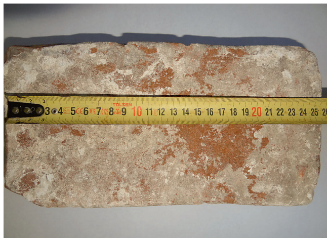
Рис. 2. Керамический кирпич 265 × 140 × 65 мм, отобранный из здания исторической застройки – стены (прясла)
