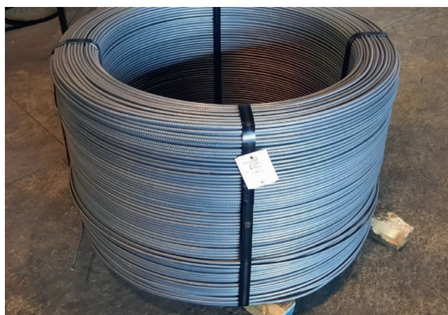
Рис. 1. Произведенная в РФ арматура класса A500CNU повышенной пластичности с четырехсторонним периодическим профилем в бунтах рядной смотки
