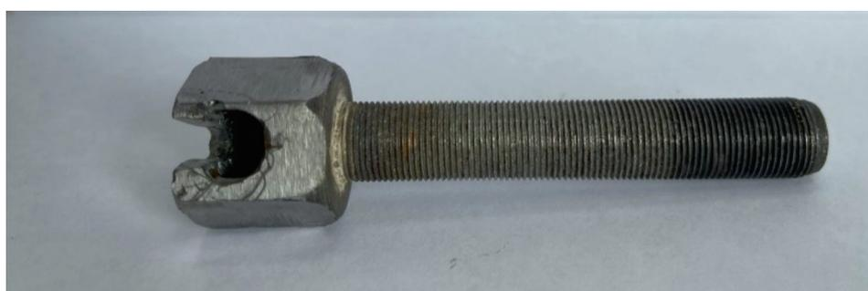
Рис. 4. Захватное приспособление для испытания дюбеля на вырыв, устанавливаемое в прибор ПОС-50
