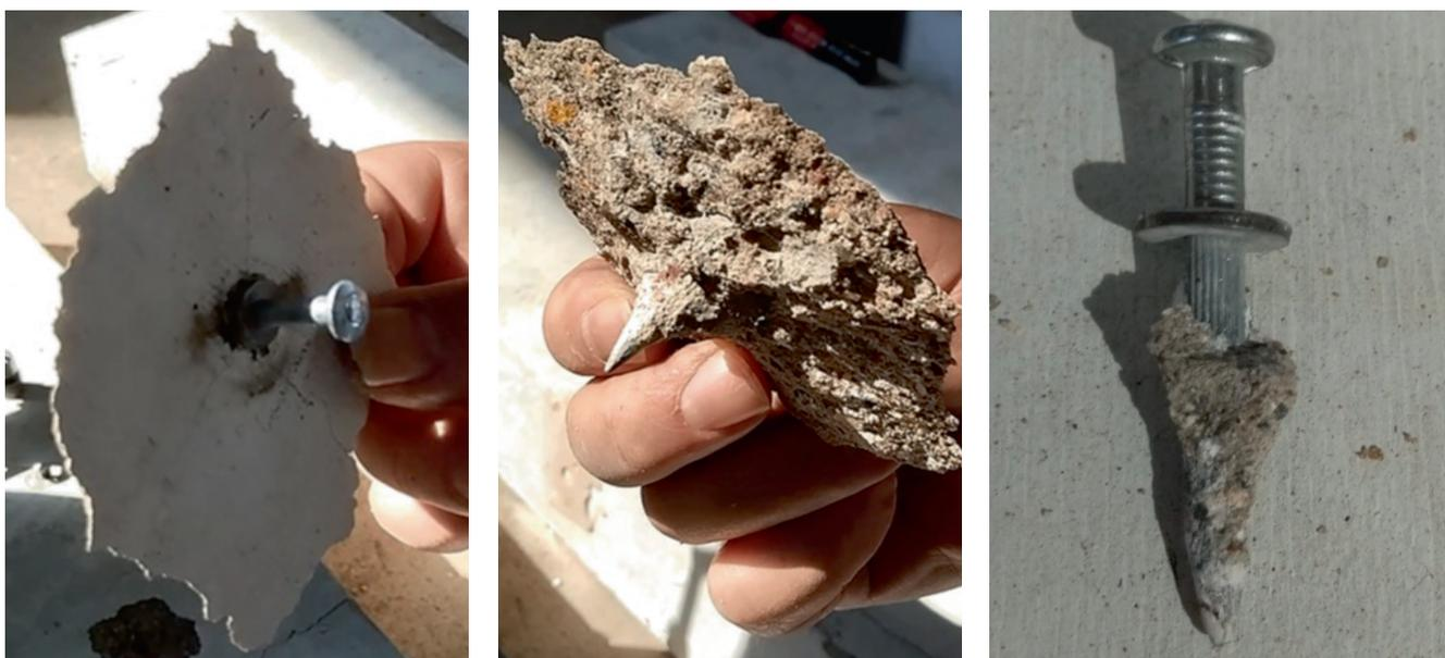
**Рис. 1.** Конус выкалывания и вид дюбеля после испытания на вырыв
