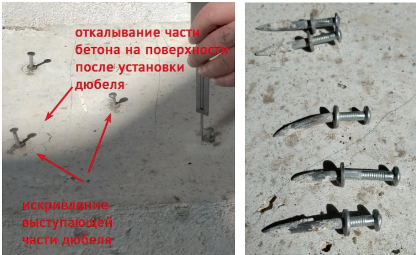
**Рис. 5.** Искривление выступающей (а) и заглубленной (б) части дюбеля
